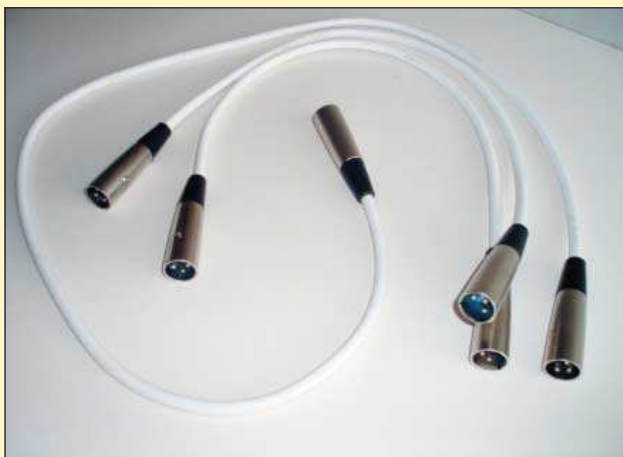
Fot. 6. Przewody połączeniowe z wtykami XLR (dłuższy przewód – z połączeniem „skróconym”).
