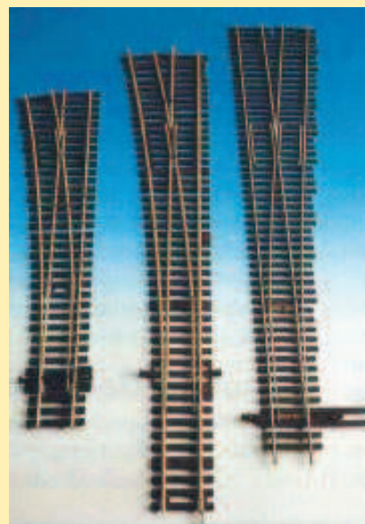
Fot. 4. Porównanie rozjazdów zwyczajnych: Peco 12°, Roco-Line 10°, Shinohara 7°09'.
