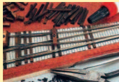
Fot. 3. Montaż rozjazdu dostarczanego przez producenta w elementach (Shinohara).
