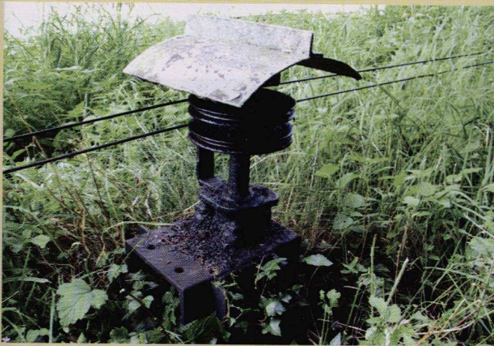
Starsza wersja (odkryta) i wersja całkowicie zamknięta (wykonanie gospodarcze) zwrotu odchylnego.
